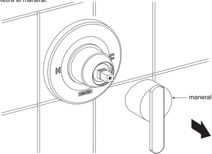
c) Desenrosque el chapetón, la tuerca, retire el cartucho usado y reemplácelo, si es necesario.
