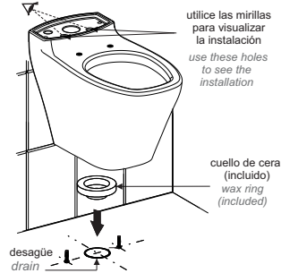
instalación con cuello de cera wax ring installation
