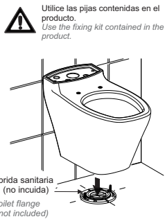
instalación con brida sanitaria toilet flange installation
